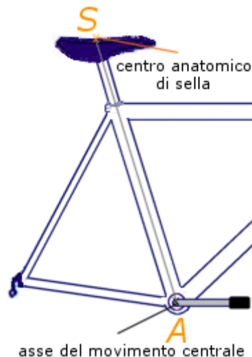
Figura 6: Il segmento AS rappresenta la quota relativa all'altezza di sella. Il centro anatomico di sella S è il punto dove cade l'appoggio ischiatico che sorregge il ciclista.
